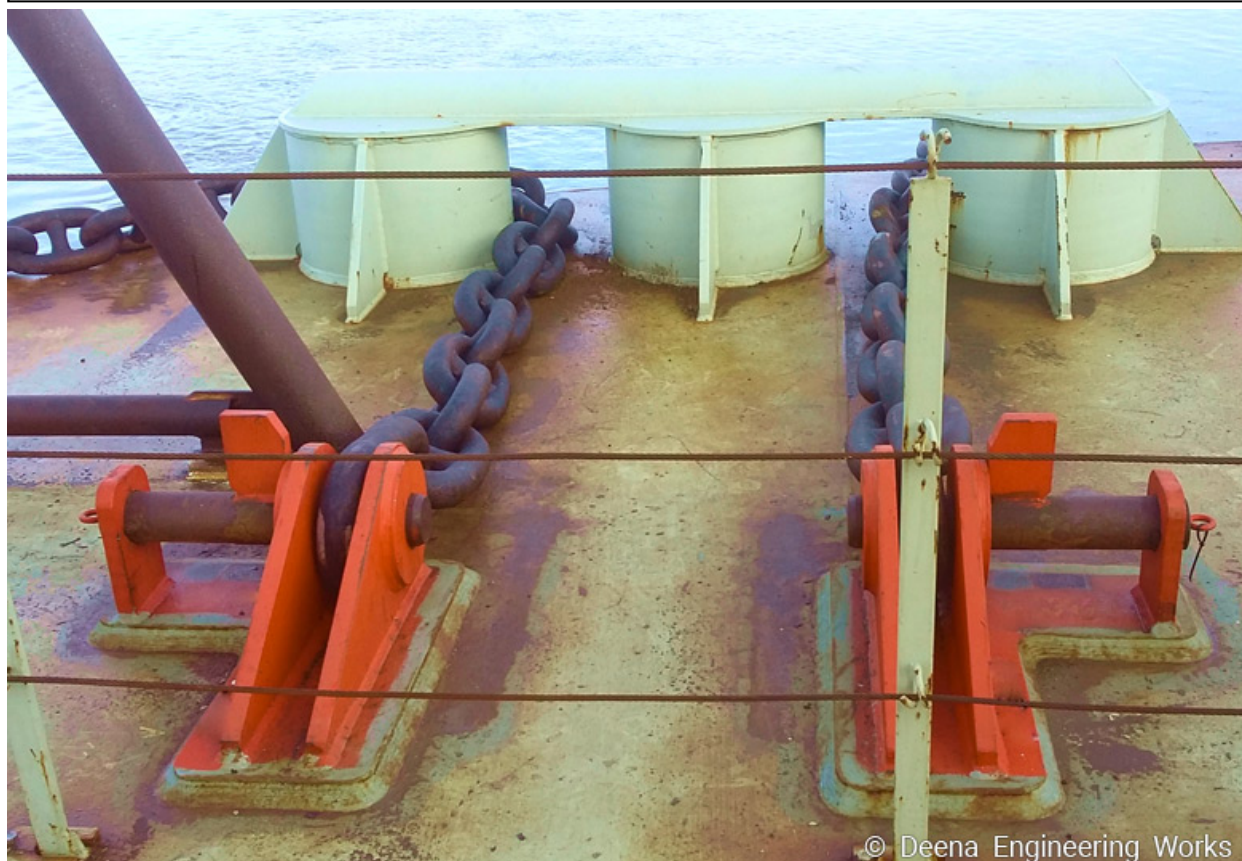
Рисунок 18. Система аварийной буксировки с бракетой Смита
