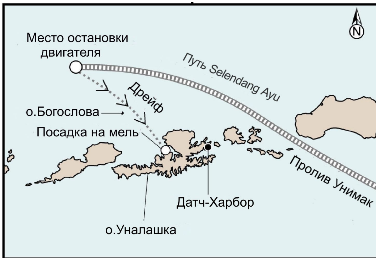
Рисунок 11. Схема посадки на мель балкера «Selendang Ayu»
