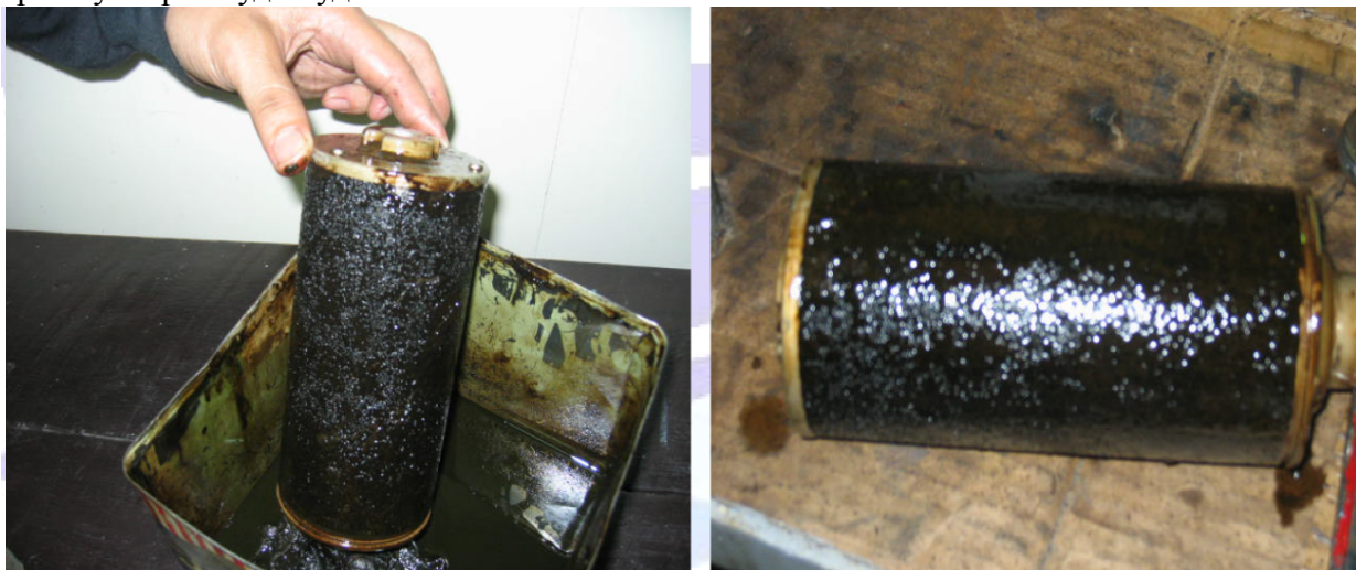
Рисунок 13 Засоренные топливные фильтры – причина аварии
